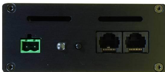
Anschlüsse Eingangsseite des µCon-Boosters
