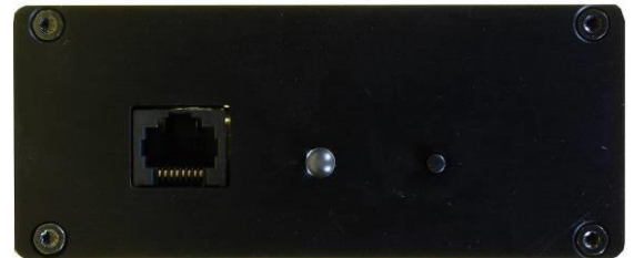
Anschlüsse Ausgangsseite des µCon-Managers
