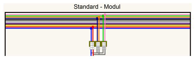
Die Zuführungen zur Platine werden an der Hauptversorgung des Schienensystems entsprechend dem Farbsystem für die Boosterkreise angelötet. Ab der Steckerseite (im obigen Bild unten) kann nun die entsprechende Schienenversorgung innerhalb des Moduls verkabelt werden.
