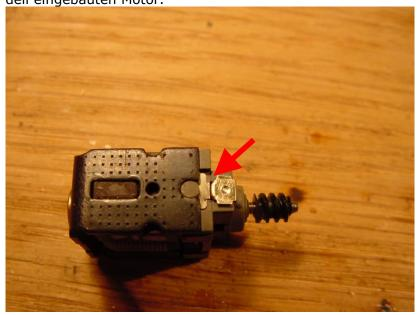
Das kleine Plättchen neben dem Kohlenbürsten-Halter ist diese kleine Verbindung. Diese kann mit einem kräftigen Ruck mit einer Pinzette entfernt werden. Sehr wichtig, sonst qualmt
