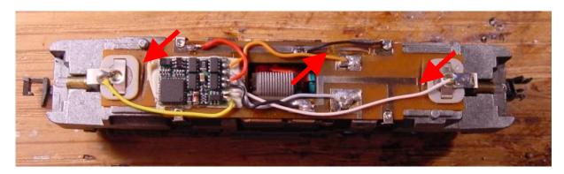
Anschließend ist der Decoder wie im Bild zu Verkabeln. Ferner wird im Bild am oberen Motorkontakt die Verbindung für die Stromabnahme – die durch die Trennung des Motorkontakts entstanden ist – mittels eines Decoderkabel-Restes hergestellt. Die Stromabnahmen liegen an der oberen seitlichen langen Leiterbahnen und der in der Mitte verlaufenden Leiterbahn, die Motorsteuerung direkt neben der Motoröffnung und die Lichter werden oben auf die Diodenplättchen angelötet.
