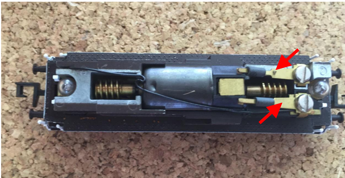
(Bild 1: Originalzustand, notwendige Trennungen für Schiene / Motor)
