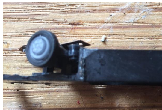
(Bild2 und Bild3: Positionierung der Lenkachse auf dem Chassis)
