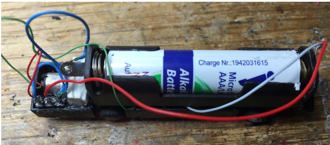
(Bild 9: Lage Akku und Endverkabelung)
