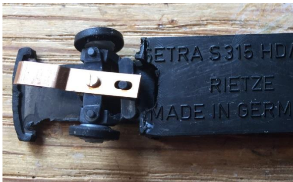
(Bild2 und Bild3: Positionierung der Lenkachse auf dem Chassis)
